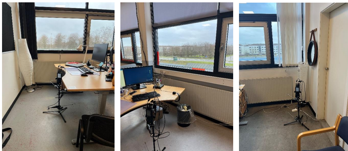
Figur 4: Målepunkter for lufthastighed ved arbejdsplads (billede 1 og 2) og kant af opholdszone (billede 3)
